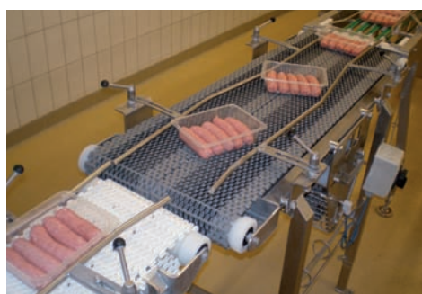
Schalen-Drehförderer Turning conveyor for trays
