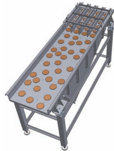
Vibrationsförderrinne für die Sortierung von Frikadellen
