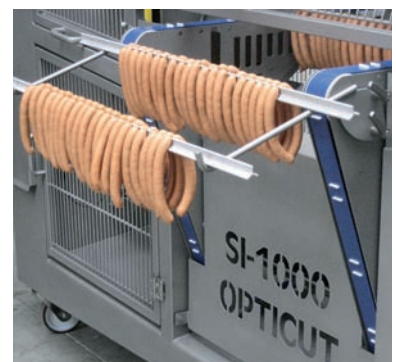
Die getrennten Wurstpaare am Auslauf auf der Gegenseite der Anlage The separated sausage pairs at the discharge position on the opposite side of the system
