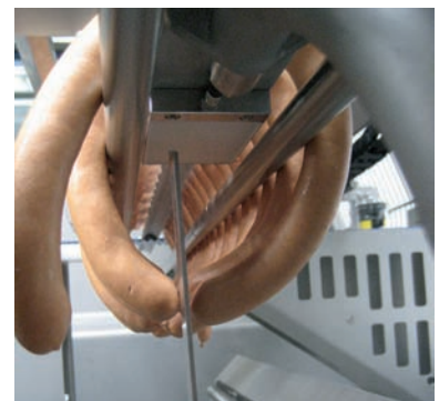
Die Wurstpaare werden gespreizt und dann unten durch das Messer exakt getrennt The sausage pairs are spread and then separated exactly from below by the cutter
