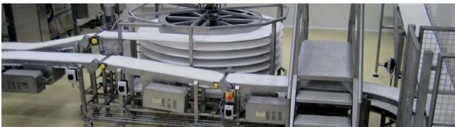
Pufferspirale mit Zu- und Abtransportstrecke. Buffer spiral with a feed and discharge line.
